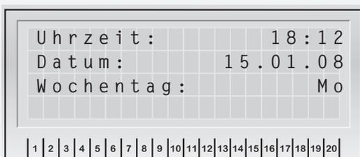
Über die Navigationstasten werden das Datum und die Uhrzeit der Realtime-Clock eingestellt. „OK“ wechselt zur nächsten Stelle. Die Einstellung des korrekten Wochentags ist zur Ausführung des automatischen Funktionstests notwendig.
