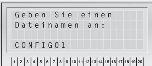
Zuerst ist der INOSTICK an die Tastaturbuchse des CLS-Gerätes anzuschließen. Es ist ein Dateiname für die Konfigurationsdatei anzugeben. Mittels der Pfeiltasten kann das Zeichen gewählt werden, „OK“ springt zur nächsten Stelle und „ESC“ löscht das Zeichen.
