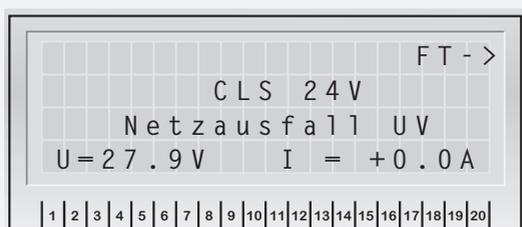
Eine Phasenüberwachung hat angesprochen und unterbricht die Stromschleife SL+/SL-. Überprüfen Sie die überwachten Unterverteilungen. Die Phasenüberwachung zeigt die fehlende Phase an.
