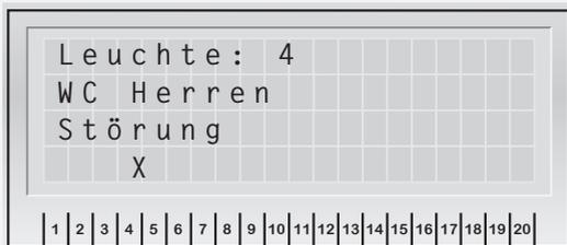
Nach Auswahl des Stromkreises werden die gestörten Leuchten mit Zielort angezeigt. Mit den Pfeiltasten kann zur nächsten Störung gewechselt werden. „ESC“ wechselt in das vorherige Menü.
