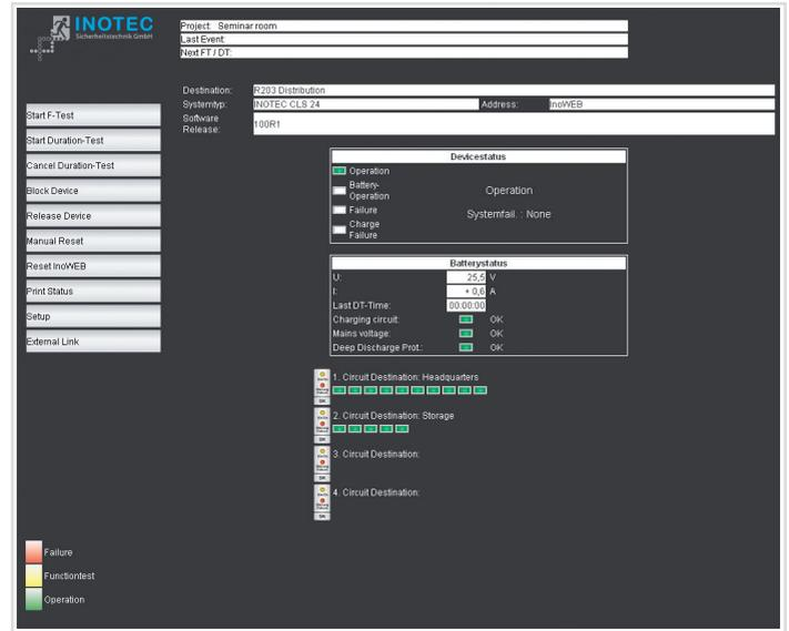
Über die INOWEB-Schnittstelle können die Statusinformationen zur Leuchte mittels eines Webbrowsers dargestellt werden. Dazu wird das CLS-Gerät in ein lokales Netzwerk eingebunden.
