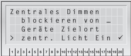
Ist das Gerät an ein CLS-MTB angeschlossen und die Option aktiviert, schaltet es bei Erkennung von Netzausfall UV oder Netzausfall HV eines anderen CLS-Gerätes am CLS-MTB oder Erkennung von Netzausfall UV des CLS-MTBs mit ein. Weitere Informationen finden Sie hierzu in der Bedienungsanleitung des CLS-MTB.
