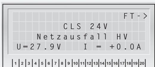
Bitte überprüfen Sie die Netzzeinspeisung. Das Gerät arbeitet so lange im Batteriebetrieb bis wieder Netzspannung an den Eingangsklemmen anliegt oder der Tiefentladeschutz angesprochen hat.
