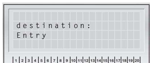
In dem Gerät kann ein Zielort mit maximal 20 Zeichen hinterlegt werden. Dieser wird auch in einer angeschlossenen Visualisierung angezeigt.
