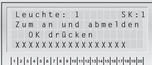
Mit den Navigationstasten wird die Leuchtenadresse ausgewählt, über OK wird diese an- bzw. abgemeldet. Nur angemeldete Adressen können programmiert werden und melden Störungen.
