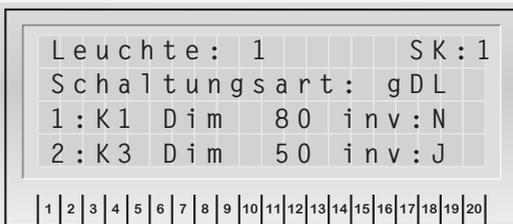
K1-K4 gibt den Kanal für die systeminterne Lichtschalterabfrage an. Für jede Zuweisung kann ein Dimmwert angegeben werden, mit dem die Leuchte bei eingeschaltetem Kanal betrieben werden soll. Über die Option „inv“ wird der Eingang invertiert, die Zuweisung wird bei Öffnung des Kanals aktiviert.
