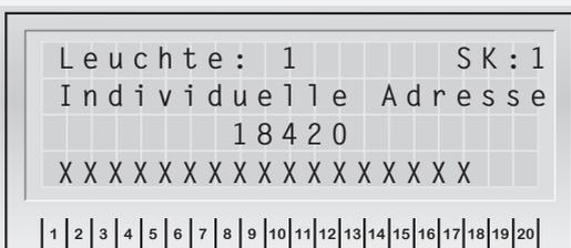
Über die Navigationstasten wird die Ziffer eingestellt, durch Drücken von „OK“ gelangen Sie zur nächsten Stelle. Das Menü wird über „ESC“ verlassen. Nach dieser Zuordnung wird die Leuchte im Menü „Leuchten Konfig.“ entsprechend konfiguriert. Dabei können für jede Leuchte individuell zwischen drei Schaltungsarten gewählt werden:
