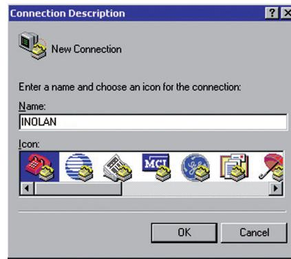
Im folgenden Dialog wird im Auswahlfeld "Verbinden über" die serielle Schnittstelle ausgewählt, die für die Kommunikation mit dem InoWeb-Modul genutzt wird. Dazu wird ein 1-zu-1 Modemkabel benötigt.
