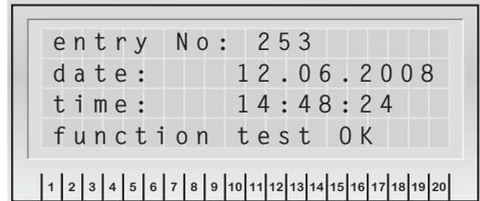
Mit den Navigationstasten kann durch die Ereignisse geblättert werden, über „OK“ sind weitere Informationen zu dem Ereignis abrufbar. Neben den Leuchten mit Störungen wird auch die Stromaufnahme des entsprechenden Stromkreises angezeigt. Über die Navigationstasten sind die Stromkreise anzuzeigen, die Taste ESC wechselt in das vorherige Menü.
