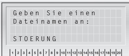
Vor Aufruf des Befehls „Störungen speichern“ ist der INOSTICK mit dem Tastaturanschluss des CLS-Gerätes zu verbinden. Nach Eingabe einer Dateibezeichnung werden die Einträge auf dem INOSTICK gespeichert. Falls der Dateiname schon vorhanden ist, so muss eine andere Bezeichnung gewählt werden.
