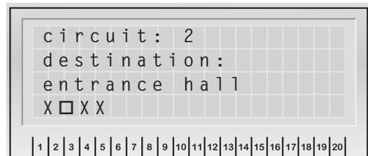
Den Zustand der Stromkreise und jeder einzelnen Leuchte werden in diesem Menü angezeigt. Nach Auswahl des entsprechenden Stromkreises, erscheinen die Leuchten mit dem Zustand. Der Index am unteren Rand zeigt, welche Leuchtenadressen belegt sind.
