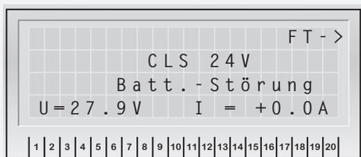
Bei einer Störung des Batteriekreises muss dieser kontrolliert werden:
