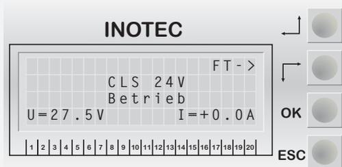
Die Bedienung des CLS-Systems erfolgt über 4 Tasten, die neben dem Display platziert sind. Die oberen beiden Tasten dienen zur Navigation, „OK“ ist zur Bestätigung bzw. Anwahl einer Funktion und mit „ESC“ wechselt man in das vorherige Menü bzw. bricht eine Funktion ab.
