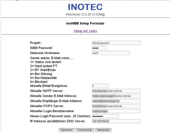
In der **Ortsangabe** (Projekt) zum Gerät kann eine Bezeichnung mit bis zu 40 Zeichen eingegeben werden, welches im Webfenster und auf den Ausdrucken dargestellt wird.
