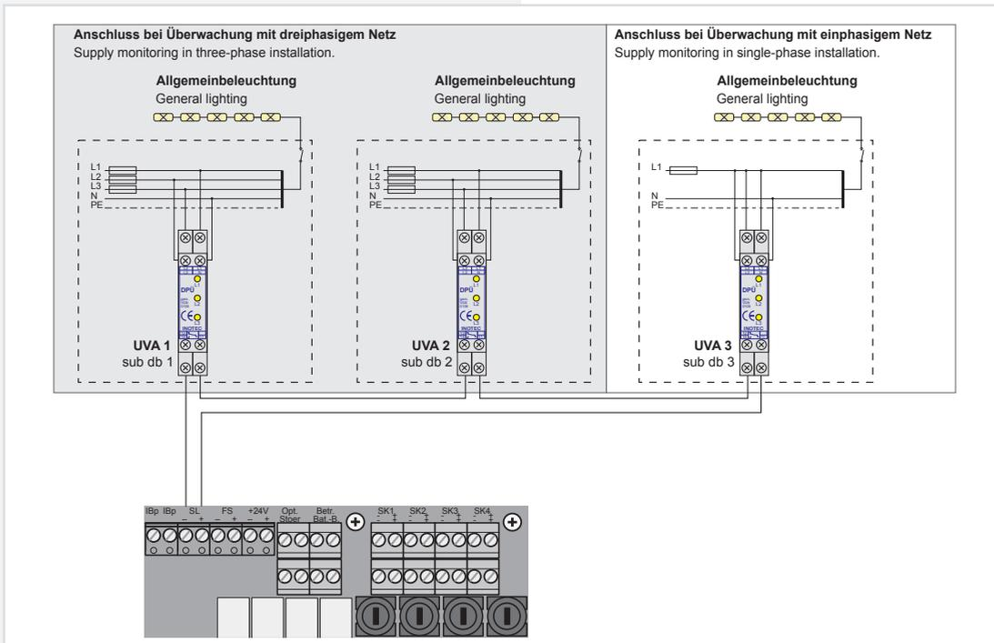
Die 24V-Stromschleife kann durch eine Schleifenüberwachung auf Kurzschluss und Unterbrechung überwacht werden. Hierzu wird eine Zenerabschlussklemme in die jeweilige Schleife geschaltet.
