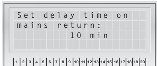
Bei Rückkehr der Netzversorgung bleiben alle Leuchten für die angegebene Zeit noch eingeschaltet. Die Zeit ist zwischen 1 – 15 Minuten frei wählbar. 0 Minuten deaktiviert die Einstellung.
