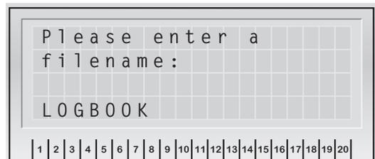
Vor Aufruf des Befehls „Prüfbuch ausgeben“ ist der INOSTICK mit dem Tastaturanschluss des CLS-Gerätes zu verbinden. Nach Eingabe einer Dateibezeichnung werden die Einträge auf dem INOSTICK gespeichert. Falls der Dateiname schon vorhanden ist, so muss eine andere Bezeichnung gewählt werden.
