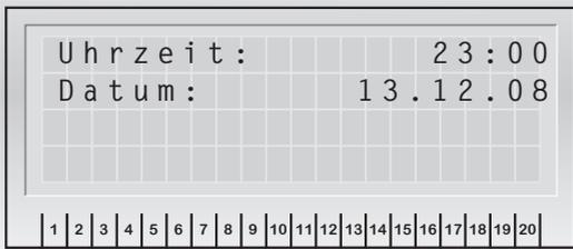
Der automatische Betriebsdauertest wird jedes Jahr zur angegebenen Zeit ausgeführt und das Ergebnis im Prüfbuch gespeichert.
